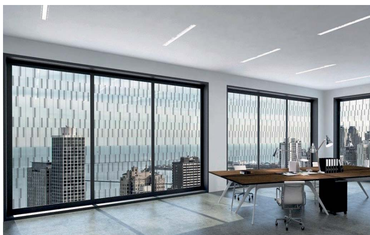
Standardowa szyba zespolona z MICRO SHADE użytym w projekcie designerskim; g = 0,10 - 0,32
