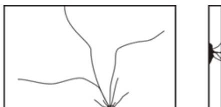
Rys. 31 WADY SZKŁA (uderzenie w krawędź)
